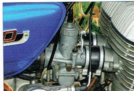
Twee Mikuni schuifcarbureurs van 34 mm
