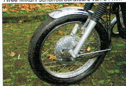
Voor een passende - nou ja: in het heetst van de strijd was het krap aan - vertraging zorgde een trommelrem van 180 mm diameter met twee oplopende schoenen
